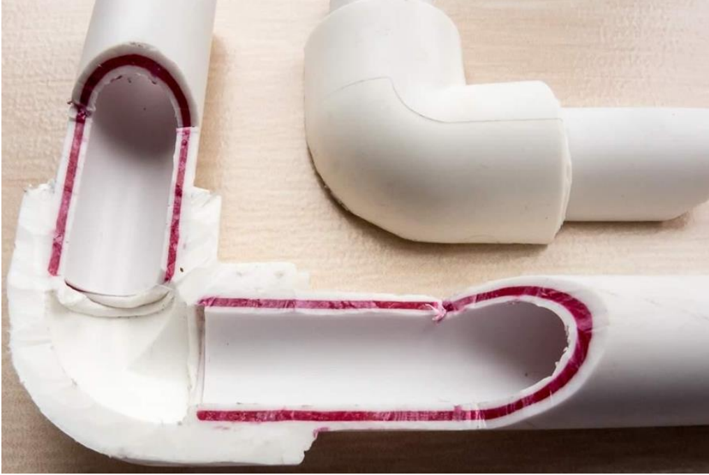
Şəkil 3.21. Polipropilen borunun qaynaq tikişlərinin daxildən görünüşü
