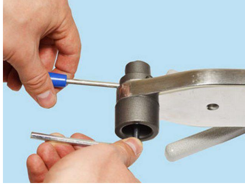
Şəkil 2.32. Gilizlərin qızdırıcı elementə bərkidilməsi
