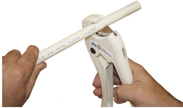
Şəkil 3.15. Borukəsən qayçı vasitəsilə borunun 90°-li bucaq altında kəsilməsi
